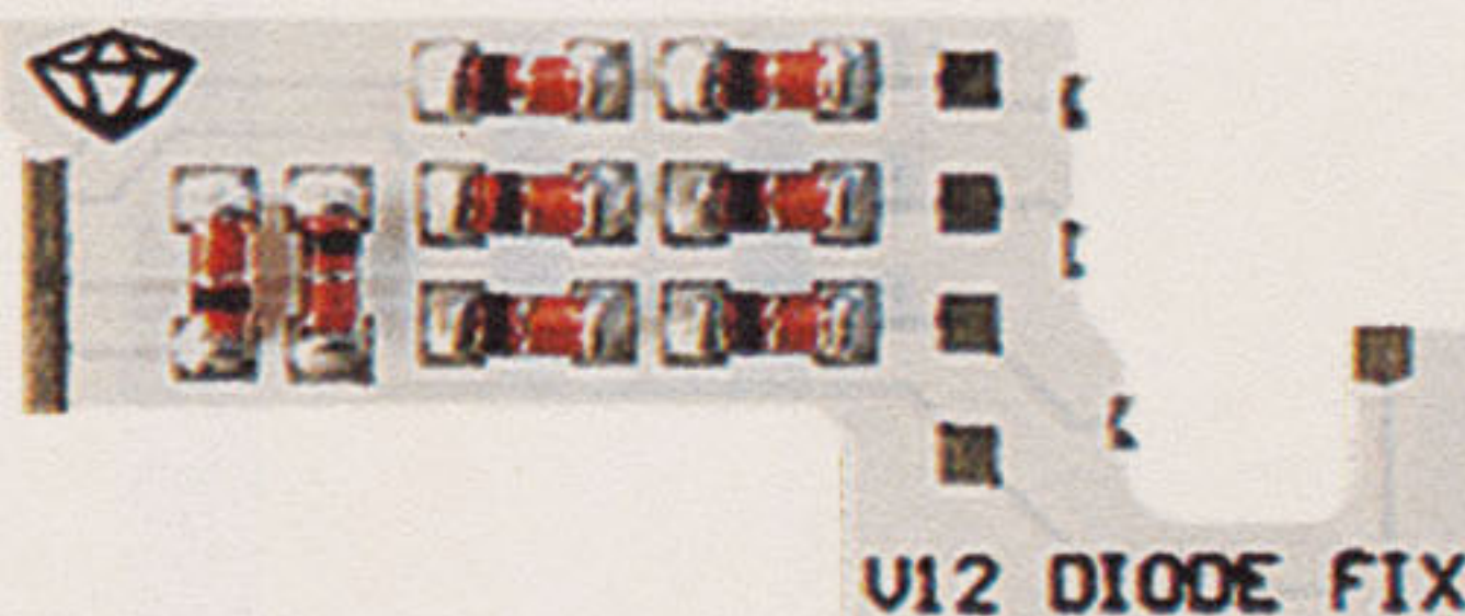
Crystal Chip pcb: placa distribuída pela Crystal Chip com a solução dos diodos. Também é o Matrix-Fix, mas sem o PIC.
